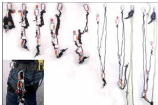
Abb. 6: „Foppe“-Flaschenzug. Von der „Daisychain“ zum Aufbau
